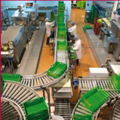
Verpackungsarbeitsplätze mit automatischer Leerbehälterzuführung
