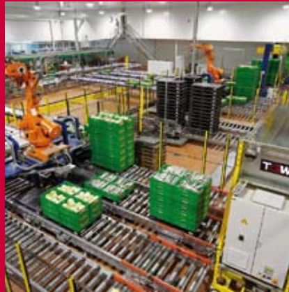
Palettierroboter bilden Auftragspaletten
