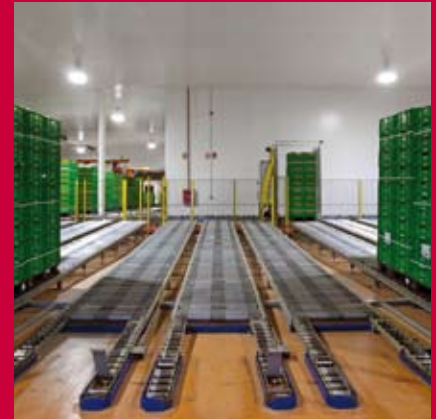
Versandpuffer mit Schwerkraftbahnen
